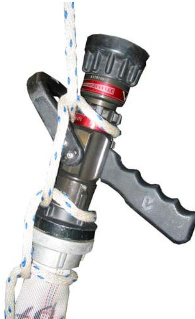
Eine Löschleitung wird zum Aufziehen vorbereitet in dem die Leine mit einem Kreuzklank über beide Kupplungshälften und mit einem ganzen Schlag am vorderen Ende des Strahlrohres befestigt wird.
